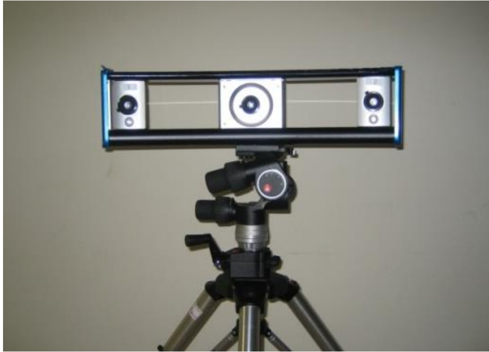
Rexcan III® (Solutionix) ハロゲン光によるパターン投影スキャナ
